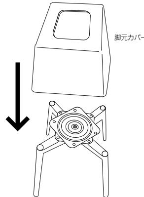
4.チェア本体を逆さにし、ワッシャーにボルト(短)を通し、脚元カバーをよけながら脚部をチェア本体に六角レンチで4ヶ所取付けます。
