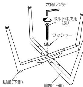
2.組み立てた脚部を逆さにして、回転金具をずらしワッシャーにボルト（短）を通し、六角レンチで4ヶ所を取り付けた後、逆さにしてボルト中央用をしっかりと本締めします。
