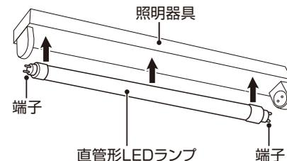
上記の取り付け方法で点灯しなかった場合、電気工事士による工事を行うことで電源直結方式でも取り付け可能です。直結工事は必ずご販売店または電気工事店にご依頼ください。
