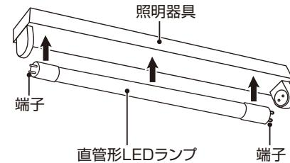
上記の取り付け方法で点灯しなかった場合、電気工事士による工事をすることで電源直結方式でも取り付け可能です。
