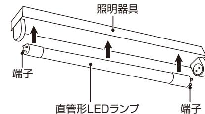
上記の取り付け方法で点灯しなかった場合、電気工事士による工事をすることで電源直結方式でも取り付け可能です。
